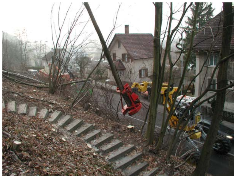
Abbildung 6: Menzi Muck mit Fällgreifer-Aggregat legt Bäume sicher ab. Das Hacken ist direkt angegliedert (Straumann 2005)
