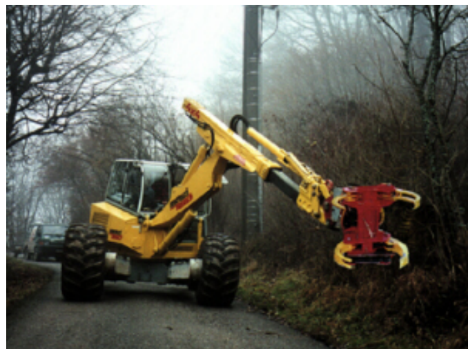
Abbildung 4: Variante 4, Menzi Muck mit Fäller-Sammler-Aggregat (Straumann 2005)
