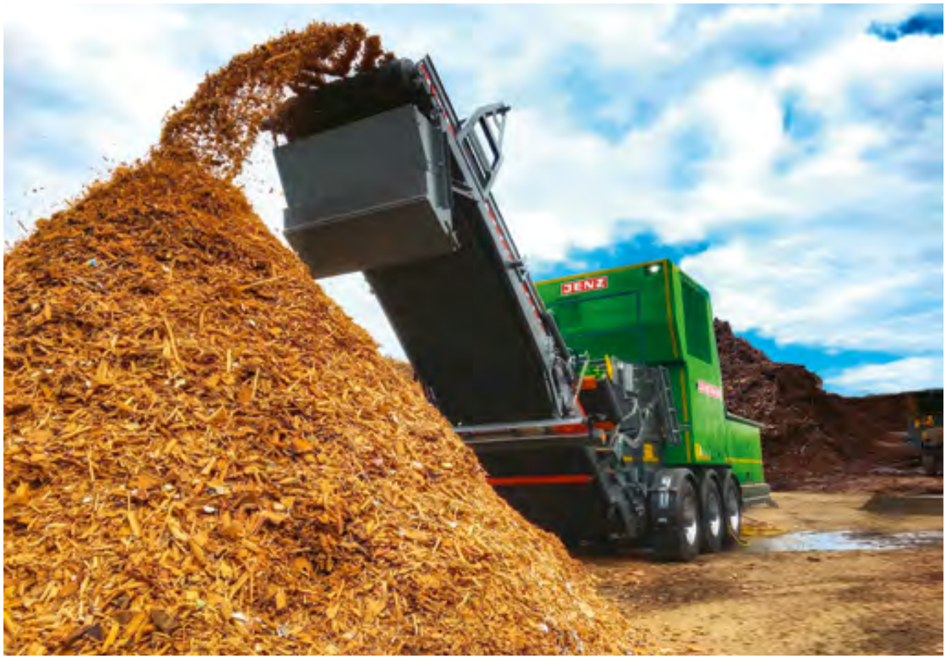
Schredder erzeugen uneinheitliche, faserige, gebrochene Holzsnitzel. Bild: Jenz
