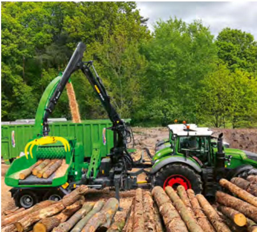
Aus Stammholz ohne Feinanteile entstehen beim Hacken gleichmässige, saubere Holzschnitzel. Bild: zVg
