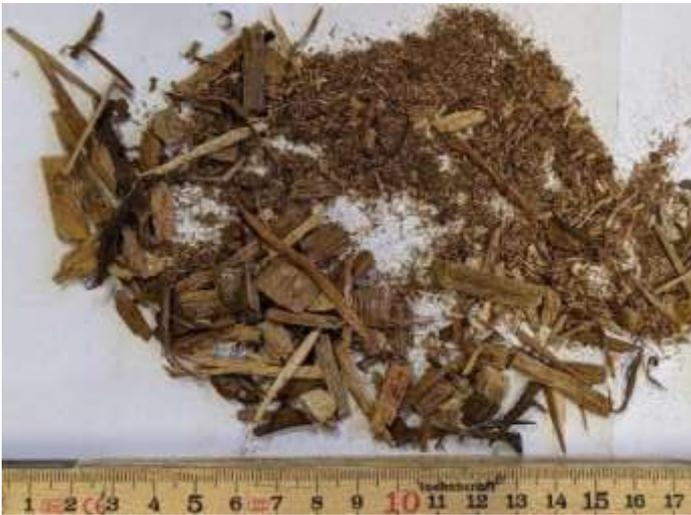
Foto 1: Campione di legna con un'elevata frazione fine e molte scaglie lunghe e sottili.
