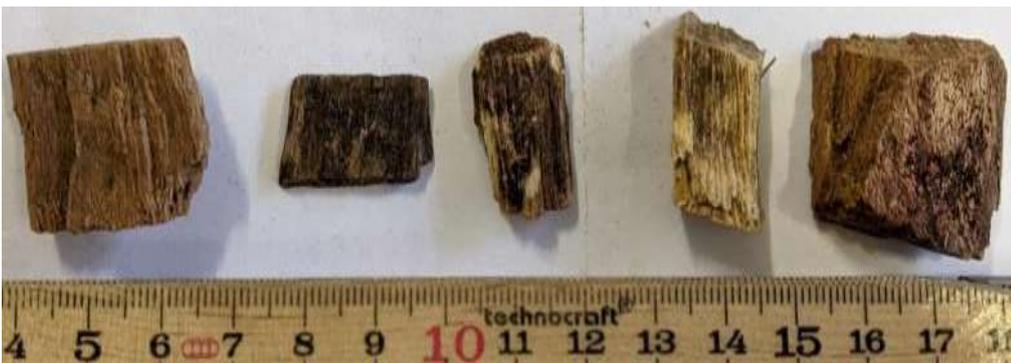
Foto 2: Cippato con netti segni di perdita di sostanza dovuta a un'infestazione fungina.
