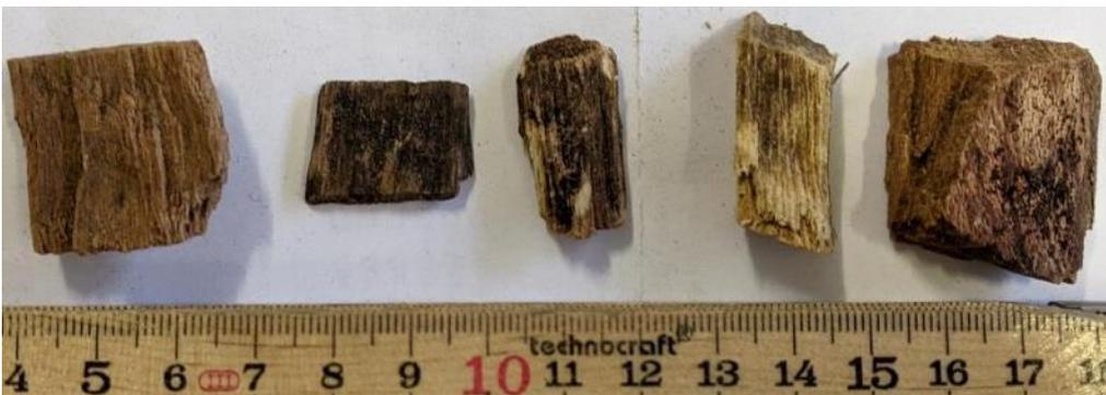
Bild 2: Holzschnitzel mit deutlichen Anzeichen von Substanzverlust durch Pilzbefall (Verstockung).
