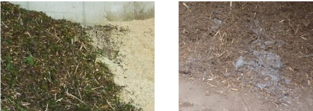
Bild 3: Links: Holzschnitzel mit einem hohen Grünanteil (Nadeln) neben solchen aus Energierundholz.
