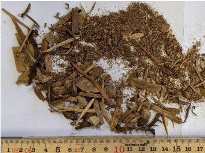
Bild 1: Holzprobe mit einem hohen Feingutanteil und vielen langen dünnen Holzschnitzeln.
