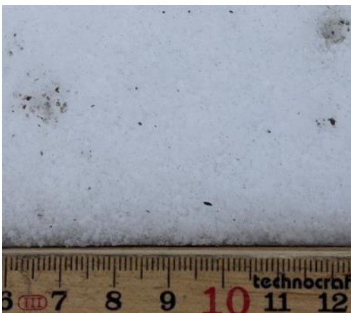
Foto 1 Due esempi di depositi attorno a riscaldamenti a legna. A sinistra: frammenti di carbone incombusti provenienti dalla camera di combustione nella neve. A contatto con l'acqua, il carbone crea una patina viscosa. A destra: i fiocchi di fuliggine formatisi in un precipitatore elettrostatico con dimensioni fino a 5 mm.
