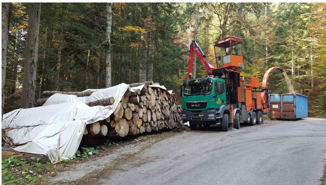
Figure 6 : production de plaquettes forestières dans la région de Charmey à partir d'une pile de grumes recouverte de papier.
