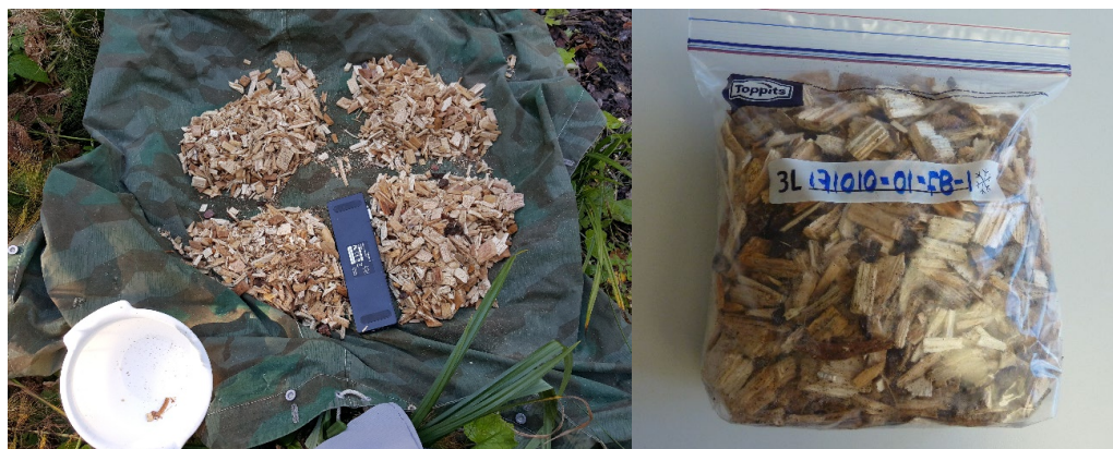
Figure 8 : exemple de collecte et de mise en sachet d'un échantillon de plaquettes forestières. Six prélèvements sont mélangés et une partie est ensachée. L'échantillon est envoyé le jour-même pour que l'analyse de la teneur en eau puisse être effectuée dans les jours suivants. La contenance du sachet est de 3 litres et le poids en plaquettes est inférieur à 1kg.
