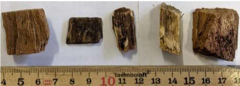
Bild 2: Holzschnitzel mit deutlichen Anzeichen von Substanzverlust durch Pilzbefall (Verstockung).
