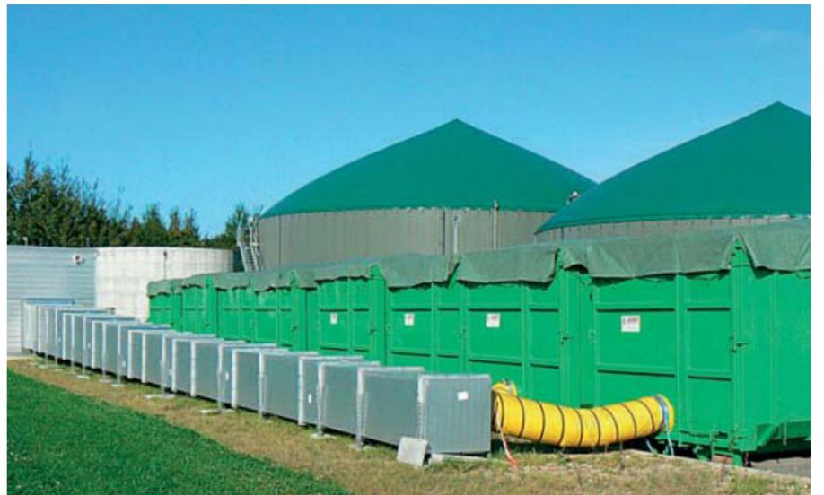
Mobile Containertrocknung mit Abwärme aus einer Biogasanlage. (Moser, 2015).
