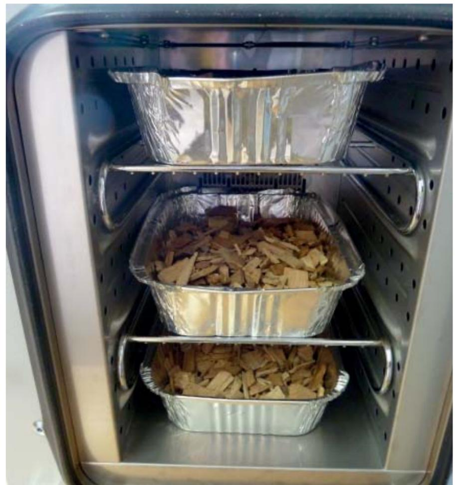
Darrtrocknung im Trocknungsöfen.
